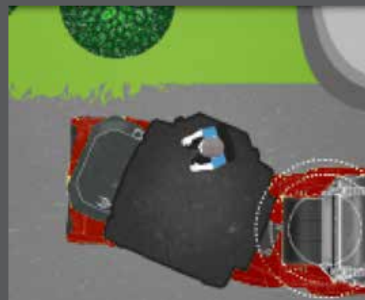
СМЕЩЕНИЕ ЦЕНТРА ТЯЖЕСТИ К ЦЕНТРУ ДОРОГИ Центр тяжести катка, движущегося вдоль неукрепленных кромок полотна, может быть смещен ближе к центру дороги.
