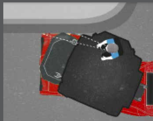
НАИЛУЧШЕЕ УПЛОТНЕНИЕ Качественное уплотнение вдоль бордюра и препятствия.
