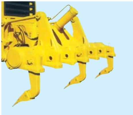
**Задненавесной рыхлитель:** Рыхлитель с параллелограммной подвеской. Данный рыхлитель с гидравлическим механизмом подъема и опускания можно использовать для выкорчевывания из земли валунов или разработки прочного грунта, не поддающегося рыхлению кирковщиком.
